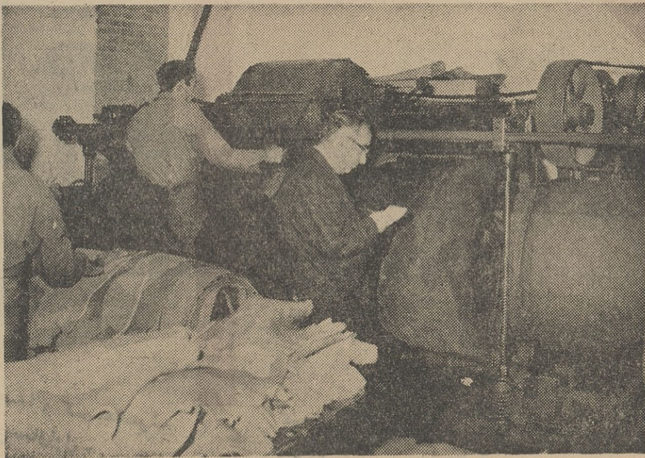
پس از طی مراحل نگاه که پوست بصورت چرم در آمد در کارخانه های چرم سازی به زیرماشین های پرس که ستن فشار دارد می رود تا خوب پهن و ظریف شود.
