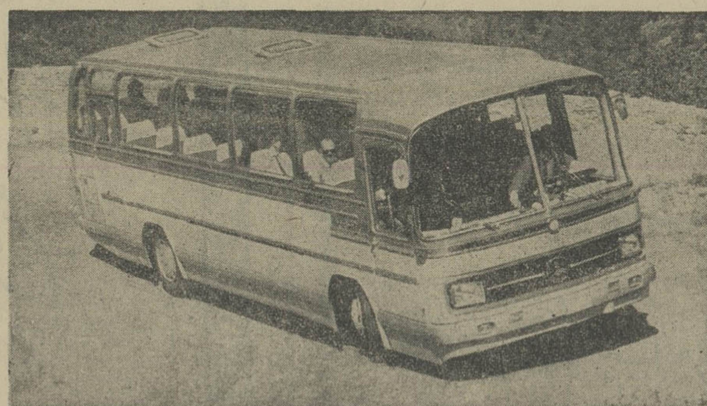
اتوبوس لوکس مسافری ۴۰۴ با موتور دیزل. باسه‌اندازه فاصله چرخ موجود است. صندوق بار تا ۵۶ متر مکعب
