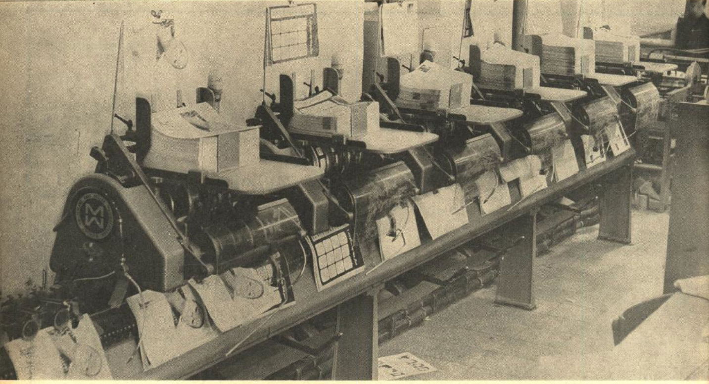
مجله «زن روز» تنها هفتگی ایران است که کار صحافی آن با دست انجام میشود و ماشین صفحات مجله را پس از چاپ تا میزنند و سپس آنها را ترتیب می‌کند و بعد با مفتول می‌دوزد و در دسته‌های پنجاه تایی بطور اتوماتیک بسته‌بندی می‌کند
